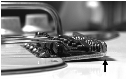
22. ここからは弦交換後に必須の調整。まず1度全弦のチューニングをしてください。その後、ブリッジがどのくらい浮いているかを確認。
