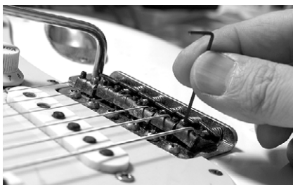
25. それから弦高のチェック。調整はブリッジ上に並んでいる駒(サドル)にある六角レンチを回してお好みの高さになるように調整します。
