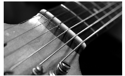
21. 全部の弦が正確にナットの溝の上に乗っているか確認。弦の太さを大幅に変更する場合、ナット溝を再調整する必要があります。
