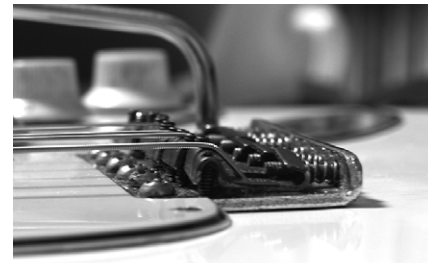
24. ネジを締めればブリッジはボディにくっついていきます。逆に緩めれば浮きます(浮いていなければアーム・アップはできません)。
